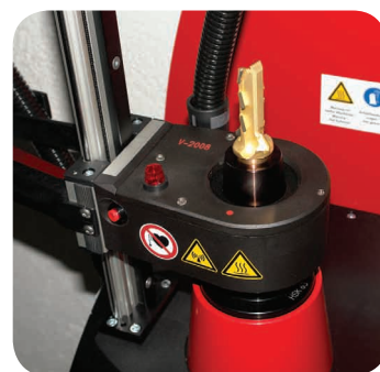
Proces zagrijavanja i hlađenja termoprihvatnika s alatom
